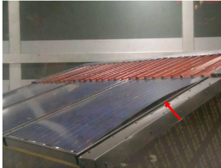
Figure 11 : Vue de la maquette à une incidence de 135 ° au moment de la rupture
